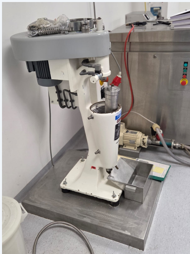
Abb. 1: Gesamtansicht der Zentrifuge mit Auffangbecken
