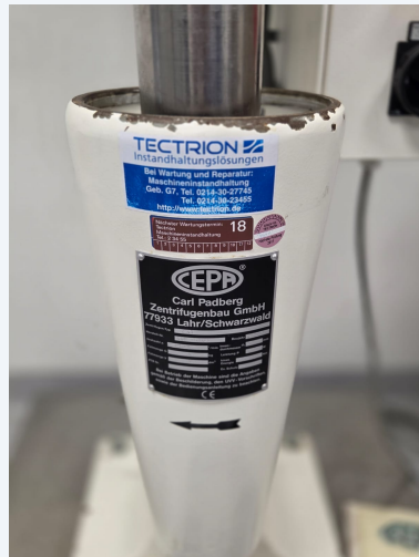
Abb. 2: Original-Typenschild und Wartungsplakette
